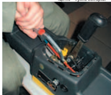
▼ Дрючим супер-пулер штырь... Щетно - нужна болгарка.
